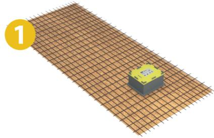
1 Ausschneiden der Bewehrungen im für die Aussparung vorgesehenen Bereich. Einsetzen und Befestigung des RÉZABOITE Querwölber auf dem Schalungsboden.
